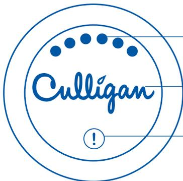
Luces de Capacidad del Filtro: Enseñan 1-6 luces dependiendo de la capacidad del filtro que le quede, 6 luces = >80% y 1 luz = <10%.
