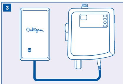
Instale cuatro baterías C (no incluidas) en la caja de pilas y enchufe al gato en la parte inferior de la caja de control.
