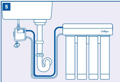
Conecte la salida del sistema de filtración al puerto titulado "RO/Filter<" de la caja de control. Moje el extremo del tubo de plástico con agua y empújelo en el adaptador de conexión rápido aproximadamente 5/8" hasta que pare.
