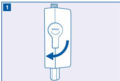
Asegúrese que la válvula de derivación esté en la posición cerrada (apuntada hacia abajo).
