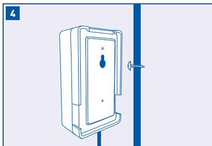
Use el tornillo provisto para colgar la caja de baterías a la pared interior del gabinete.
