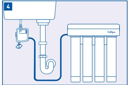
Conecte la entrada del sistema de filtración al puerto titulado "RO/Filter>" de la caja de control. Moje el extremo del tubo de plástico con agua y empújelo en el adaptador de conexión rápido aproximadamente 5/8" hasta que pare.
