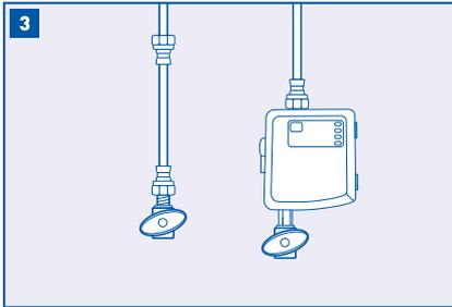
Aprieta la caja de control a la válvula de cierre de agua fría según el diagrama. Aprieta la parte inferior de la línea de agua fría a la parte superior de la caja de control.
