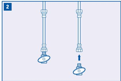
Desconecte la línea de agua fría de la válvula de cierre de agua fría.
